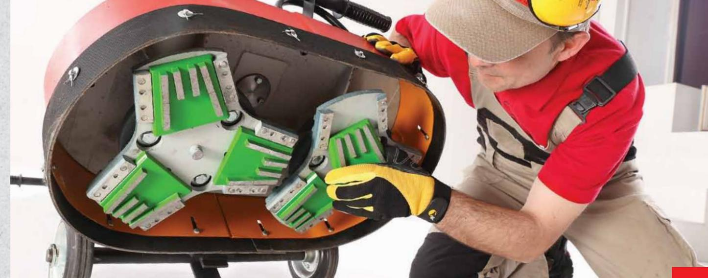
Установка франкфуртов на мозаично-шлифовальную машину СО-327Ф производства минского завода «МиСОМ»
